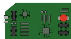
Auffinden der Fehlerstelle auf der Baugruppe mit Hilfe des integrierten Laserpointers
